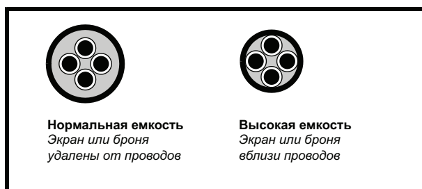
Рис. 4-15 Конструкция кабеля влияет на его емкость
