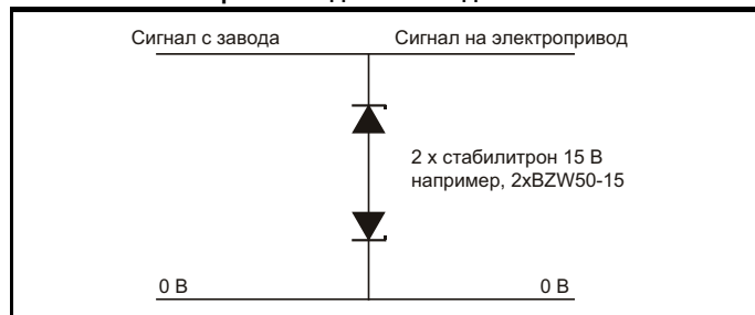
Рис. 4-42 Подавление выбросов для аналоговых и биполярных входов и выходов
